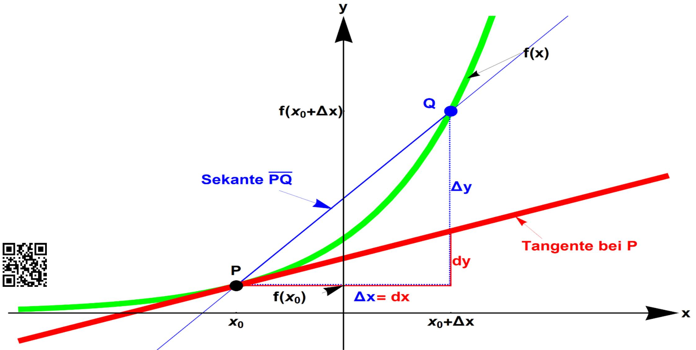
Abb. 6.1. Sekante und Tangente bei P. Das Video LINK zeigt, wie eine Sekante in die Tangente von  $f(x)$  an der Stelle P übergeht.
