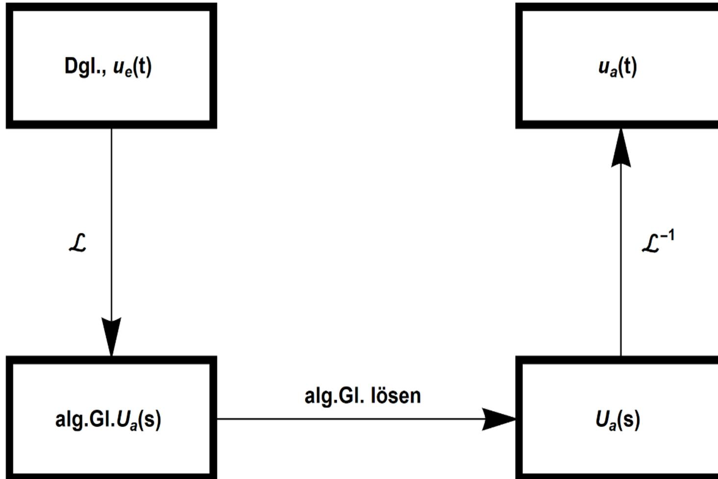
Die Auflösung der algebraischen Gleichung im Bildbereich nach  $U_a(s)$  führt zu einer Multiplikation des Eingangssignals  $U_e(s)$  mit einem Faktor  $H(s)$ :
