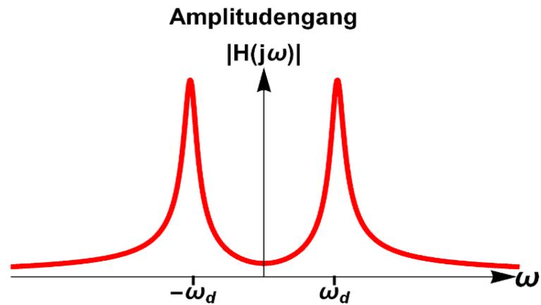
Wenn die Realteile der Polpositionen sich von negativ zu positiv ändern, wird das System instabil.
